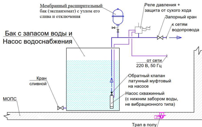
Рисунок 11 Принципиальная схема организации системы водоснабжения из накопительной емкости
